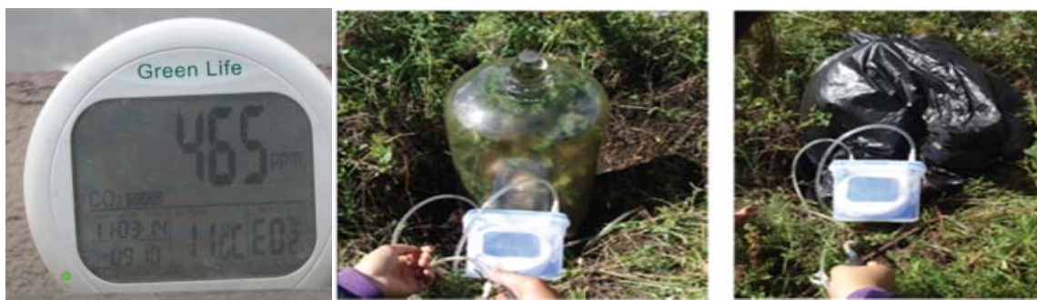
1-р зураг. Туршилтанд хэрэглэсэн агаарын \text{CO}_2 , чийг, температур хэмжигч ба түүгээр ургамал ба хөрсний системийн фотосинтез ба амьсгал хэмжиж байгаа байдал
